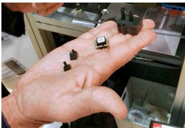
Drucksensoren mit mikroelektromechanischen Systemen (MEMS) bieten die Größe, Leistung, den Stromverbrauch und die Kosten, um viele, wenn nicht sogar die meisten IoT-Drucksensoranforderungen zu erfüllen.
